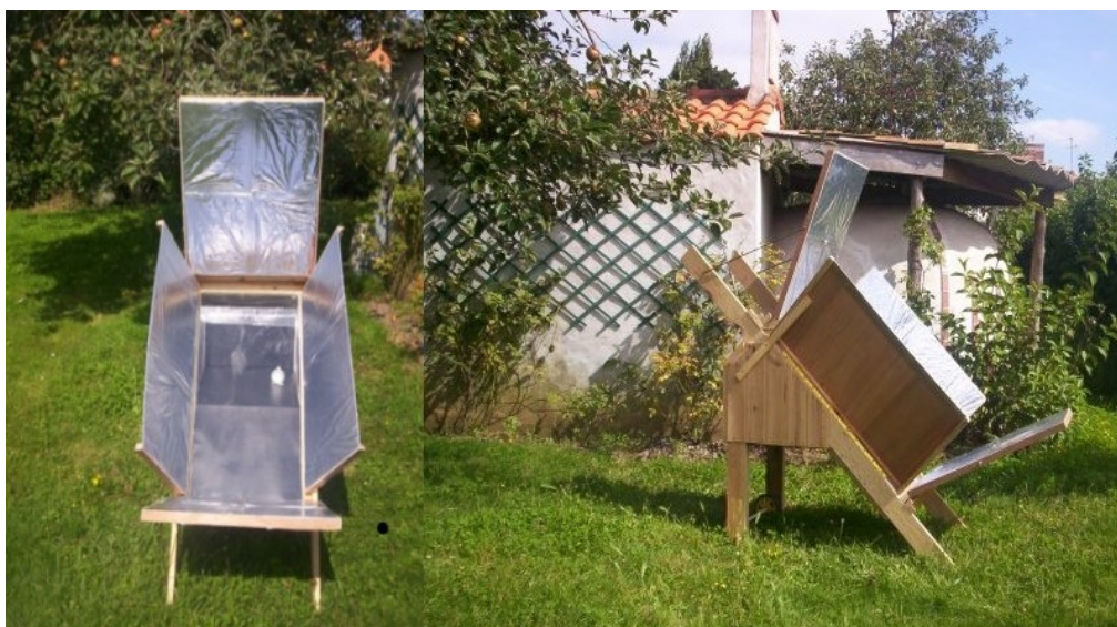
Illustration 1: Four solaire à 45° avec couloir de chauffe
